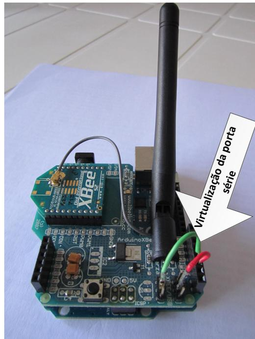
Figura 4.8: Virtualização da porta série para a comunicação entre o Arduino e o XBee.
