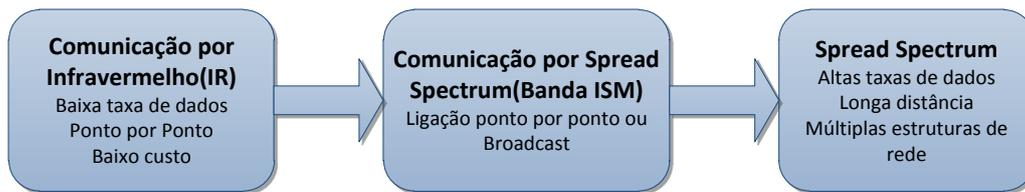
**Figura 3.1:** Evolução da comunicação sem fio entre robôs móveis.
