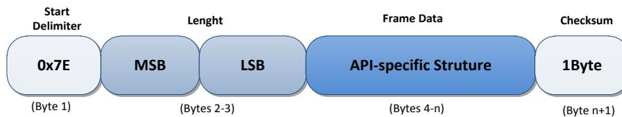
Figura 3.4: Estrutura geral das tramas em modo API.
