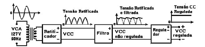
O regulador de tensão mantém a tensão de saída constante (estabilizada) mesmo havendo variações na tensão de entrada ou na corrente de saída.
