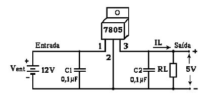
RL é a resistência da carga (LOAD) ou o circuito eletrônico que está sendo alimentado com 5V. Os capacitores C1 e C2 eliminam ruídos de RF e dão maior estabilidade na tensão de saída.
