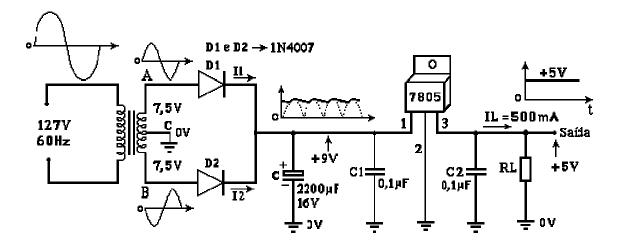
O transformador abaixa a tensão alternada de 127V (rede elétrica) para 7,5V. Os diodos retificam esta tensão alternada de 7,5V. A saída dos diodos é uma tensão contínua pulsante. O capacitor C de 2200µF filtra esta tensão pulsante e a torna mais próxima de uma tensão contínua.
