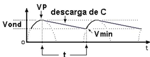
A carga elétrica armazenada no capacitor é:
