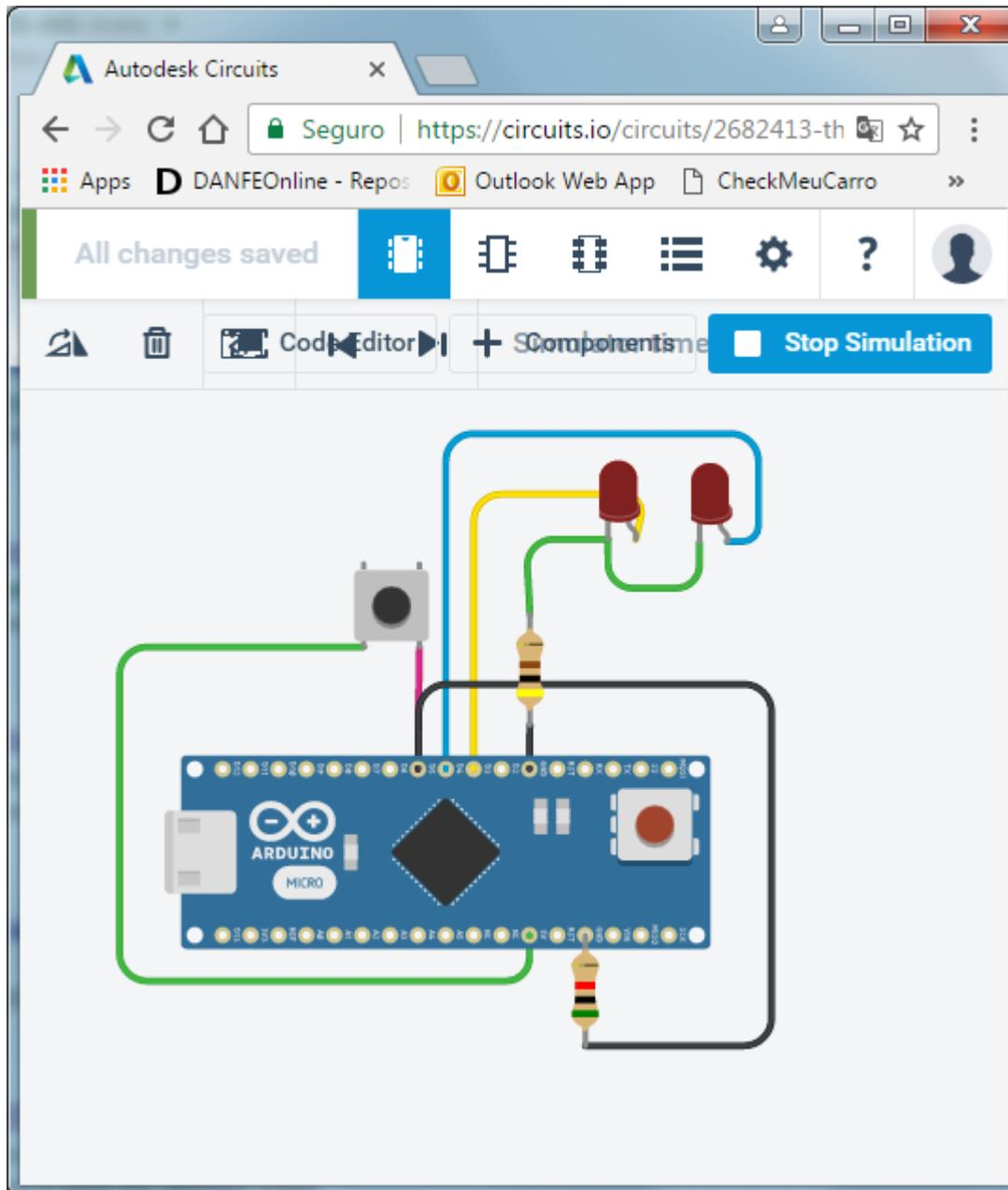
O Objetivo do circuito acima é ligar um led de cada vez, a cada vez que o botão for pressionado. Enquanto o botão se mantém pressionado, um dos leds se mantém ligado. Quando o botão for solto os dois Leds permanecem desligados. Da próxima vez que o botão foi ligado, o outro led se mantém ligado, até o botão for solto. E assim vai alternando qual led é acionado a cada vez.
